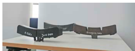
Informationen zum Anlesen und Exponate zum Anfassen, hier: Flüsterbremsen und herkömmliche Graugussbremsen im Vergleich
